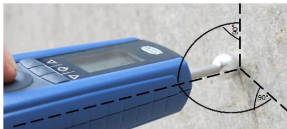
Fig. 4-3 Måling så lodret som muligt ift. målefladen.
